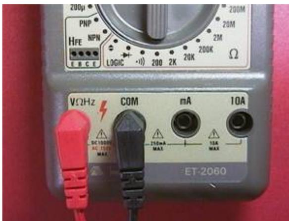
Os multímetros possuem entradas adicionais para medir altas tensões e altas correntes.
