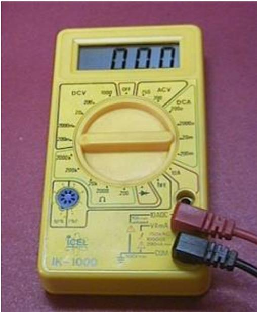
Um multímetro possui duas pontas de prova, uma vermelha e uma preta. A preta deve ser conectada no ponto do multímetro indicado com GND ou COM (este é o chamado "terra"). A ponta de prova vermelha pode ser ligada em outras entradas, mas para a maioria das medidas realizadas, a ligação é feita no ponto indicado com V-W-mA.
