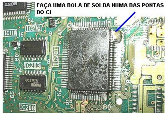
Coloque a placa em pé e cuidadosamente corra a ponta do ferro pelos pinos de cima para baixo, arrastando a solda para baixo. Coloque mais fluxo se necessário. Quando a solda chegar a baixo, coloque novamente a placa na horizontal, aplique um pouco mais de fluxo e vá puxando a solda para fora dos pinos. Se estiver muito difícil, retire o excesso de solda com um sugador de solda. Repita esta operação em cada fileira de pinos do CI. Veja abaixo:
